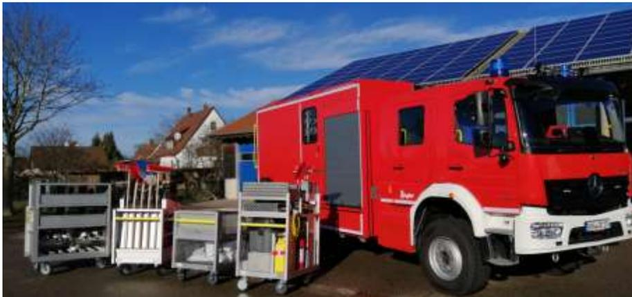
GW-L mit den RC Atemschutz, Ölspur, Gitterbox, Hochwasser (v.links)
