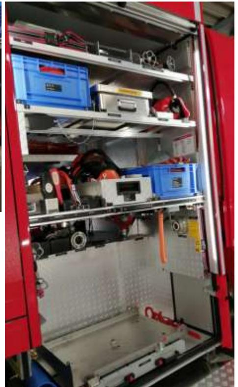
G2: Neben Armaturen zur Wasserentnahme, ist Werkzeug, die Motorsäge incl. Zubehör, sowie unten eine TS verlastet (aktuell noch im SW2 im Dienst)
